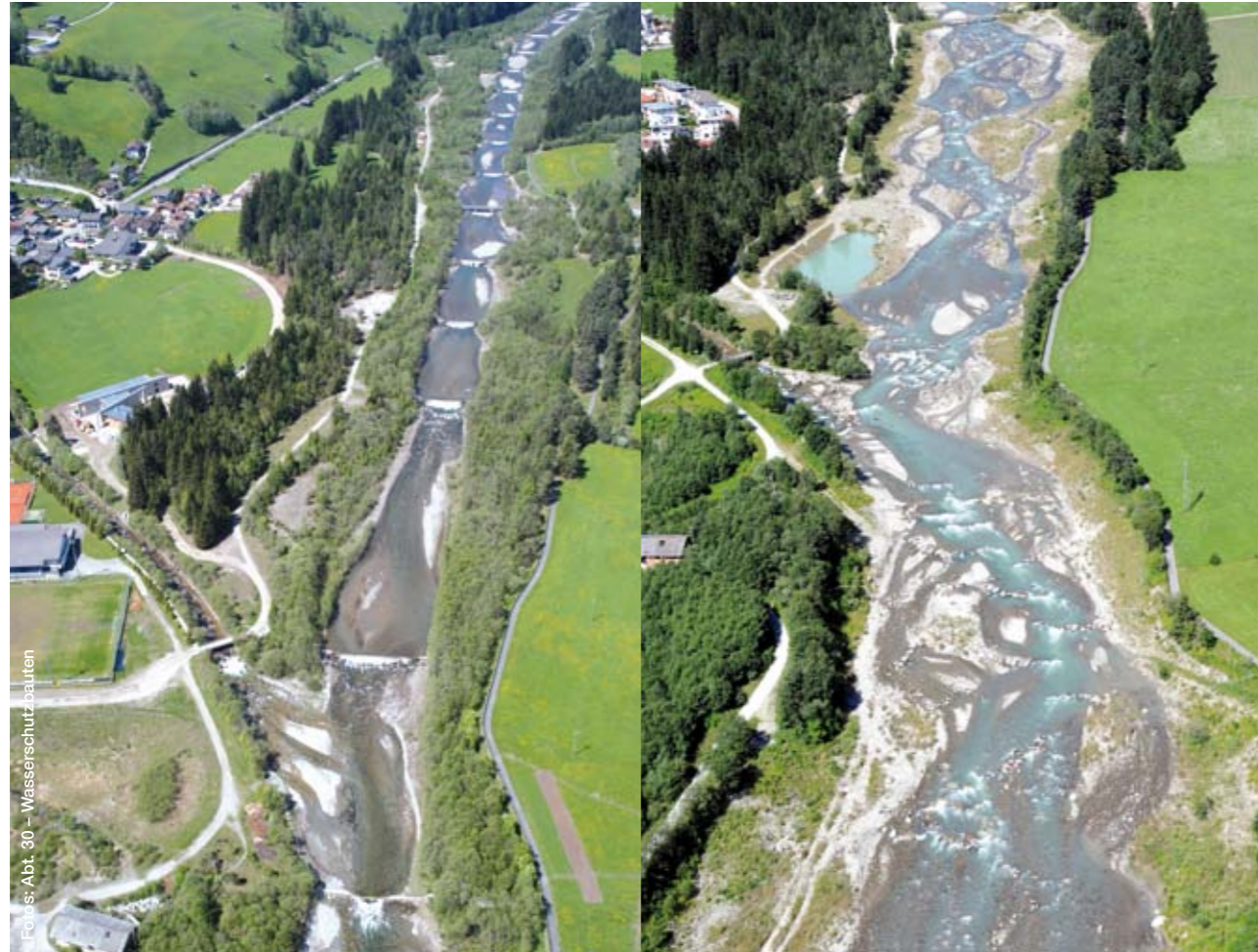
Abb. 7 und 8: Bisher größte Revitalisierungsmaßnahme in Südtirol am Mareiterbach auf der Höhe des Dorfes Stange: vor der Revitalisierung 2005 (links) und nach der Revitalisierung 2012 (rechts). Gesetzte Maßnahmen: Verbreiterung des Flussbetts, Absenken der Waldflächen, Schaffung von Stillwasserbereichen, Umbau der Sperren, Anbindung des Ratschingerbaches an den Mareiterbach
