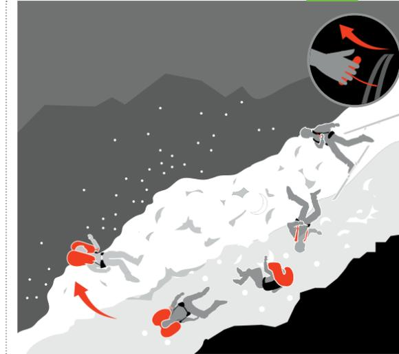
Funktionsweise der Airbag-Systeme nach dem Prinzip der inversen Segregation
