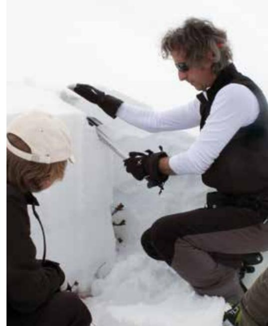
**Fabio Gheser beim erweiterten Säulentest (ECT) zur Untersuchung der Schneedeckenstabilität**
