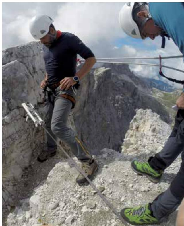
Extensometermessung von zwei Fixpunkten, die nach dem Abbruch installiert wurden. Dadurch kann kontrolliert werden ob es zu weiteren Bewegungen kommt
