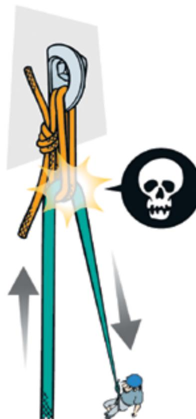
Bei Ständen mit gefädeltm Seilstück kann es aufgrund der Reibung zu Schmelzverbrennungen und in der Folge zum Seilriss kommen
