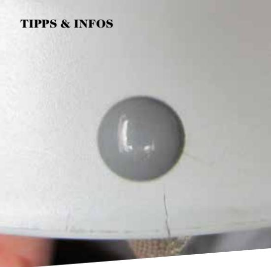
**Abb. 8:** Helme regelmäßig auf Risse und Beschädigungen an der Schale und im Dämpfungsmaterial überprüfen; beschädigte Helme austauschen!
